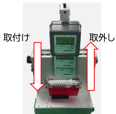
電力量計の付け外し
