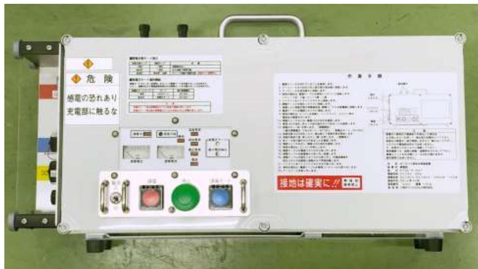
課電部：停電する配電線路へ探査電流を流す装置
