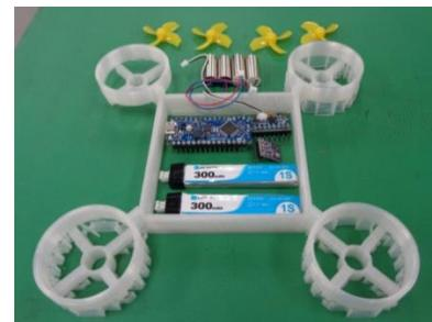
3Dプリンターで製作したドローン筐体とマイコン、モータ等
