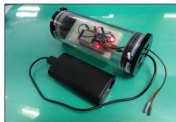
専用防水筐体に制御基板を収納
