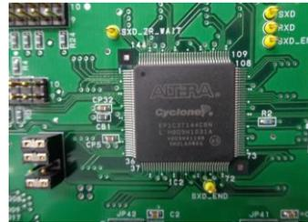
※HDLC 基板に使用した FPGA
